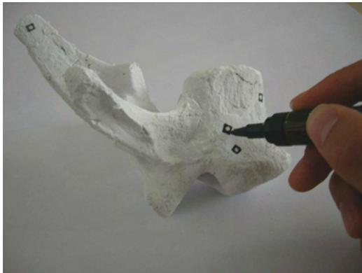
Una vez preparada la pieza, se coloca sobre la mesa y se procede a preparar la máquina digitalizadora. Se calibra para el tamaño de volumen requerido. En este caso, se utiliza el mínimo, para conseguir más detalle y para alcanzar más profundidad en los agujeros.
